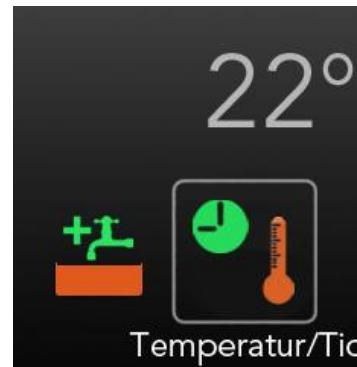
Disse ikoner viser at funktionen er aktiveret. Det tager et stykke tid inden vandet er opvarmet. En fuld beholder viser at ekstra varmvand er opvarmet og er tilgængelig.
