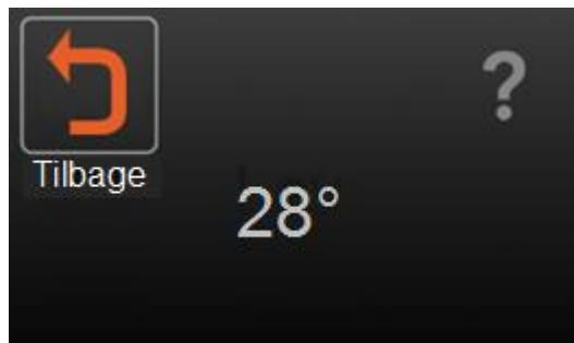
Med denne funktion kan man holde en grundvarme i cirkulationssystemet selvom der ikke er noget varmebehov i huset som helhed.
